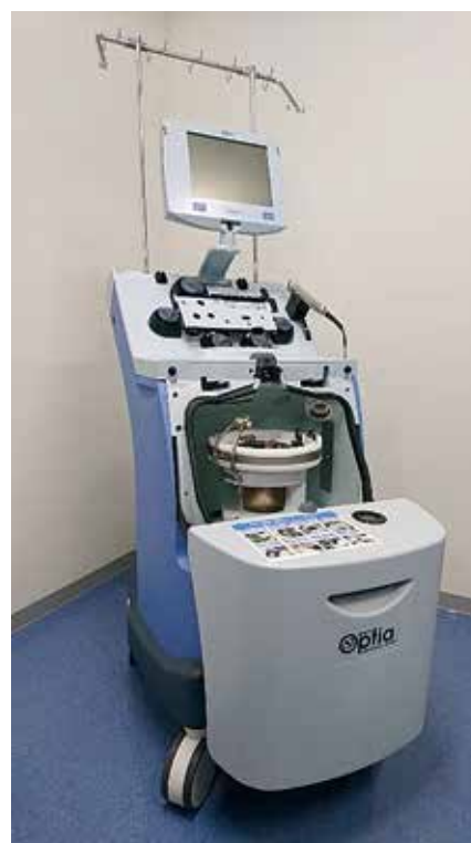
図1：本学で用いているアフエーシス装置（遠心性血液成分分離装置）です。
