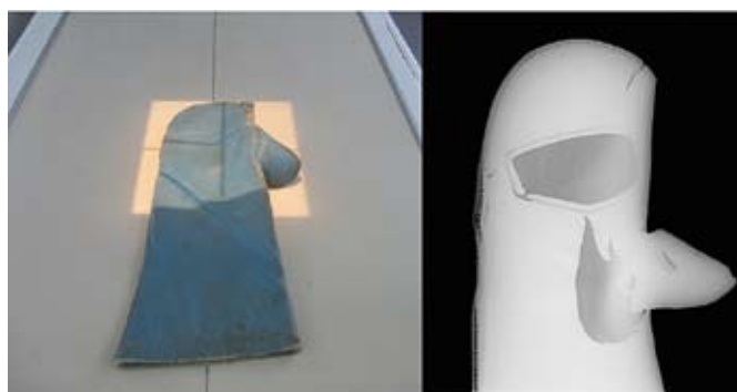
図4 一見穴の空いていないグローブでも、遮蔽物に穴が空いていることがあるので注意が必要です。
