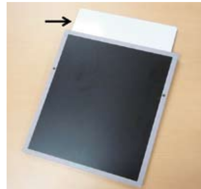
図1 CRシステムにおけるIPカセットと中に収納されているIP(矢印)
