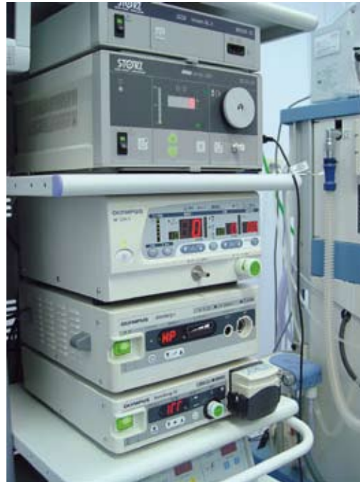
図6 装置例 画像上から ・ビデオカメラ ・光源装置 ・気腹装置 ・超音波凝固切開装置 ・超音波乳化吸引装置 ・電気メス
