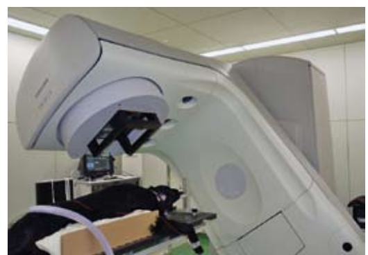
写真1 高エネルギーX線治療装置（リニアック） 動物の周囲360°自由な方向から放射線を照射することが出来ます。
